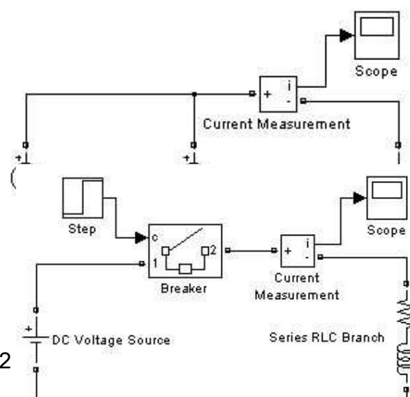
активно-индуктивной нагрузки на постоянное напряжение. Подключение источника к нагрузке обеспечивается блоком Breaker, который замыкает электрическую цепь по сигналу, вырабатываемому генератором ступенчатого сигнала Step. Измерение тока в цепи выполняется с помощью блока Current Measurement. Полученный измерителем сигнал отображается с помощью блока Scope.
